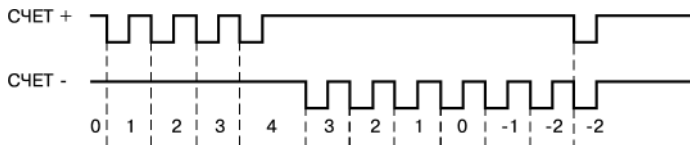
Рисунок 6.2 – Принцип работы входов «Счет+» и «Счет-»
