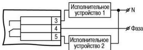
Рисунок 5.5 – Схема подключения нагрузки к ВУ типа Р
